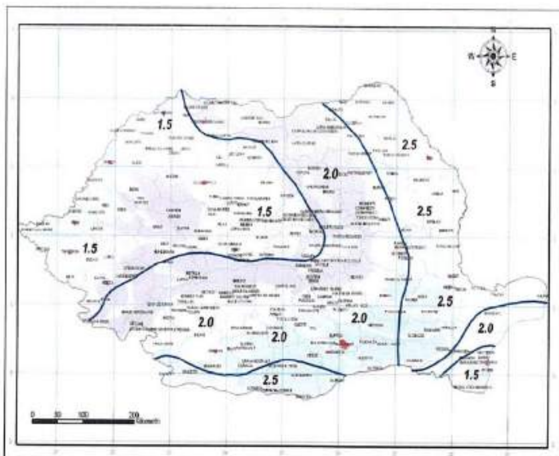
Fig.9. Zonarea valorilor caracteristice ale încărcării din zăpadă pe sol s_k în \text{kN/m}^2 , pentru altitudini A = 1000 m (conform CR-1-1-3-2012)
