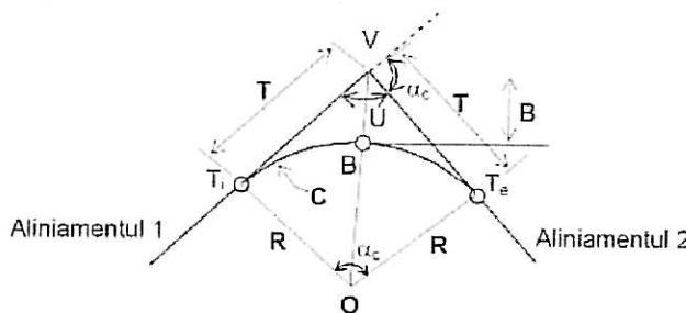
Elementele geometrice folosite pentru geometrizarea traseului în plan corespund unei viteze de proiectare de 25 - 40 km/h.
